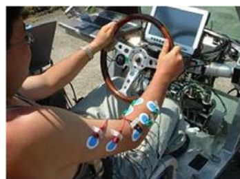
図1 車両操舵実験の状況
