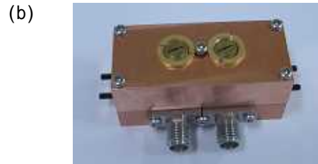
図10 2段フィルタの周波数特性(シミュレーション) (a)と作製写真(b)
