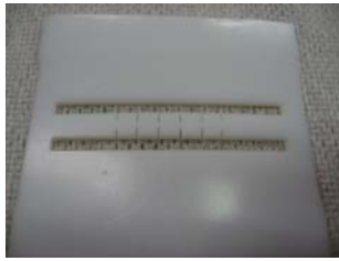
図5 放射光直接エッチングにより得られたフィルタのテフロンパターン
