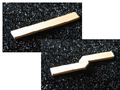
図 1 放射光によるミリ波テフロン導波管試作例
