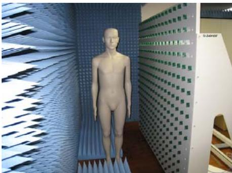
図 1 整備した 2 次元 UWB アンテナアレイ。
