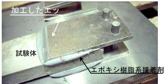
図-2 試験体とアルミプレートの接着
