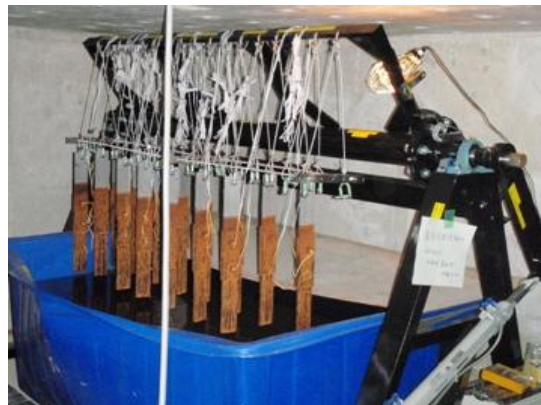
図-1 腐食促進試験状況
