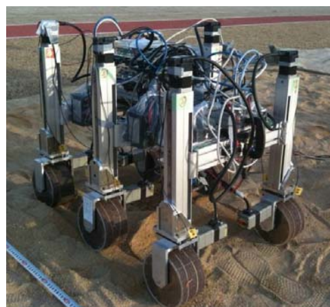
車輪 1 試作した 6 輪モデルローバー
