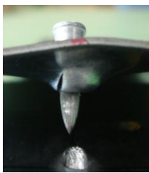
C: 釘引抜け破壊
