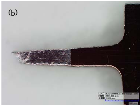
図5 (a)中央部から 0.25mm 離れた界面部の引張試験結果と (b)破断部のマクロ組織 (左側は Al 合金)。
