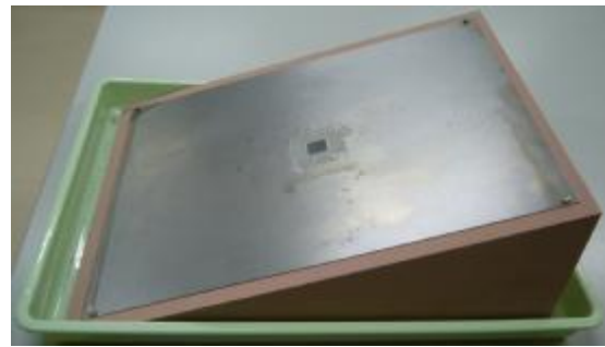
図2 試験鋼材の設置
