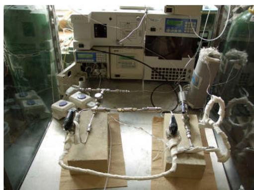
図1 超臨界 CO<sub>2</sub> 流体を利用した有機金属化合物回収システム[上: 装置構成(模式図)、下: 外観写真]
