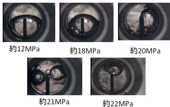
図 11 水+1-methylnaphthalene+p-xylene系における転相の相変化
