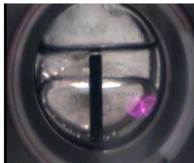
図 10 水+1-methylnaphthalene+p-xylene系における気液液平衡の相状態
