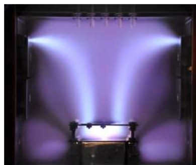
図2 VIT-2 作動一例 図中上の複数の細白線は15本プローブ
