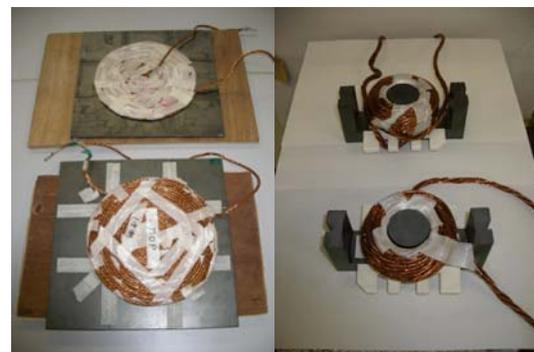
図 2 試作した送受電コイル
