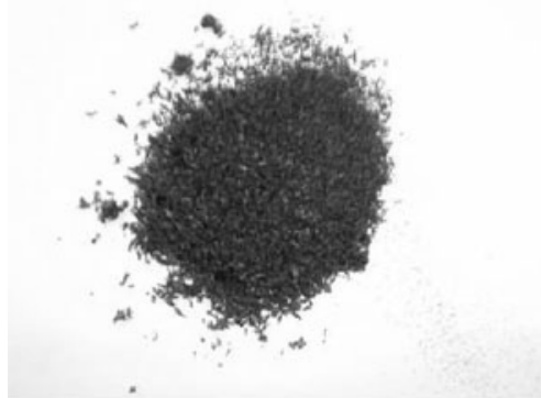
図3 腐食試験後に採取された容器内側に付着した粉末状のLi化合物
