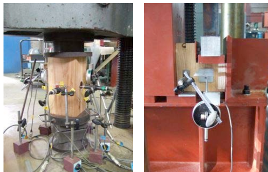
写真1 圧縮試験とブロック試験の様子
