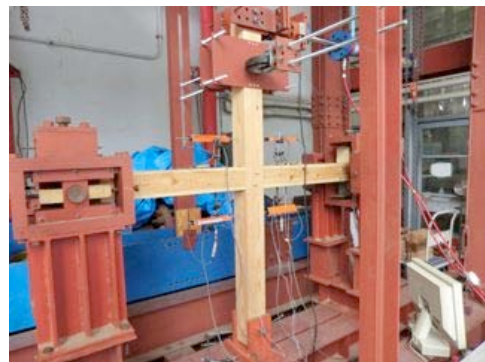
写真 3 貫十字型の柱梁仕口の曲げせん断試験の様子
