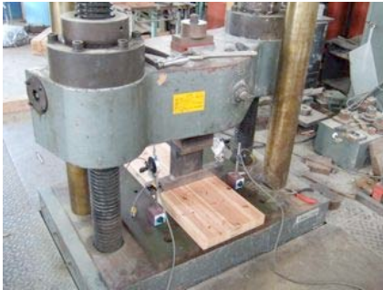
写真 2 めり込み試験の様子
