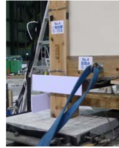
図3 石場建ての柱脚のモデル化
