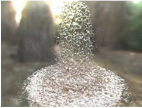
図1. 申請者らが2008年に開発した手法による、約10万粒子からなる噴水シミュレーションの可視化結果。NVIDIA GeForce 8800 Ultra 搭載のPCでの描画速度は2.3フレーム毎秒。
