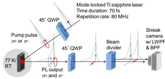
図1. キャリア寿命および電子スピンドル時間の測定系
