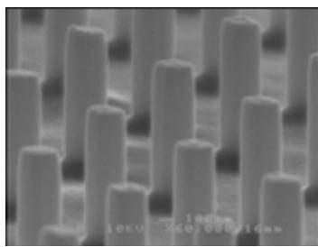
図3. エッティング条件最適化後のナノポストの電子顕微鏡写真
