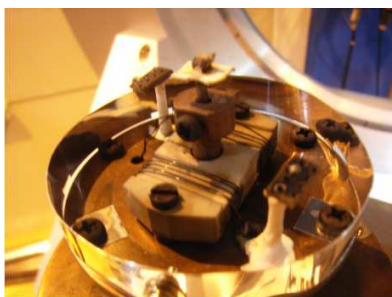
図1 電気炉にマウントした単結晶試料
