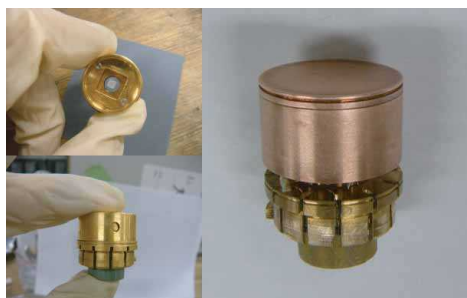
図3：（左）従来の比熱測定セルと（右）新たに開発された嫌気性物質専用の比熱セル。
