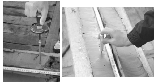
写真1 船上力学試験に使用した装置 (右: コーン貫入試験, 左: ベーンせん断試験)
