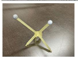
滅菌可能なレジンを用いた計測用治具の制作が終了した。
