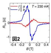
伝導効果が要求する条件と一致する。 $R_{2\omega}$ と同時に観測した縦抵抗の線形成分  $R_{\omega}$ を用いて、非相反電気伝導効果の大きさを評価するパラメータ  $\gamma=2R_{2\omega}/(R_{\omega}BI_{\omega})$ を計算したところ、 $3.1\times10^6~T^-1A^{-1}$ となり、先行研究の  $NbSe_2$ や  $MoS_2$ で報告された値と比較して 2 桁以上大きく、ドープされた
