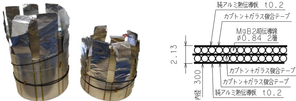
(a)  $\phi$  300 mm、長さ 250 mm(左)と 120 mm(右) (b) コイル断面
