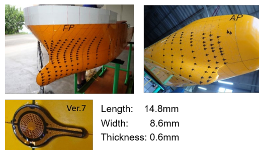
図1: FBG圧力センサと模型への貼付
