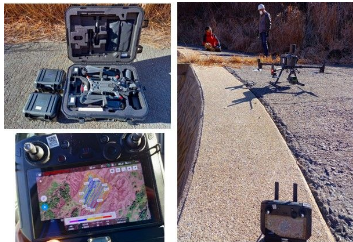
図-6 航空測量の地形データを取得するためのLiDAR ドローン．
