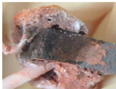
図3 静置で2.5時間の反応後の超硬チップ
