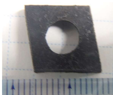
図4 回転攪拌で1.25時間の反応後の超硬チップ
