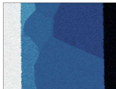
図6: 結晶粒界を含む試料において計測したCPD振動の振幅像。結晶粒界に対応する箇所で明瞭な振幅の減少(IRドロップ)が観察された。
