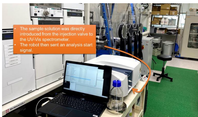
図 3. ロボットによる自動紫外可視吸収スペクトル測定
