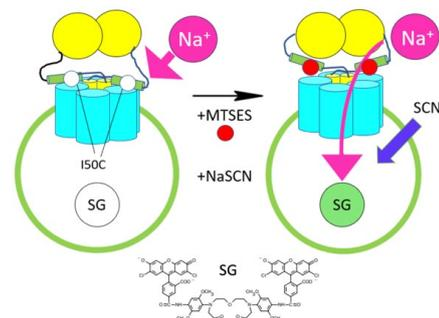
図3. MTSES による PomAB 複合体の活性化、および蛍光性 Na イオン指示薬 Sodium Green による Na イオン輸送計測の模式図。
