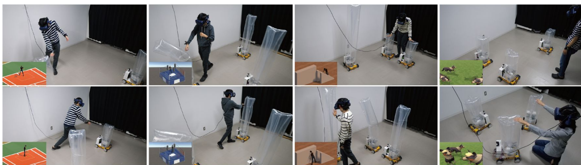
図 2 . Inflatablebots を用いた広範囲な触覚提示とインタラクション例
