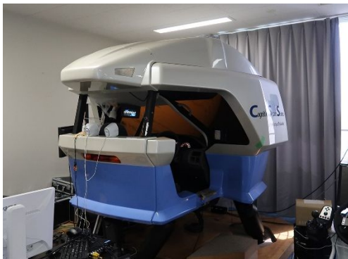
図1 動揺装置付きドライビングシミュレータ
