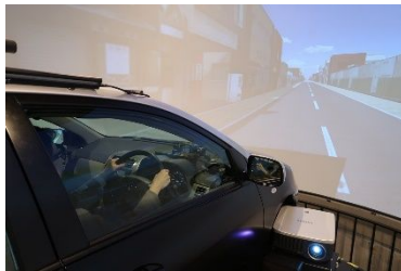
図5 全方位視野ドライビングシミュレータ(動揺装置付)
