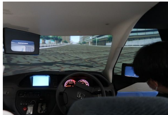
図2 動揺装置付きドライビングシミュレータの内部と前方に見えるシミュレート路面
