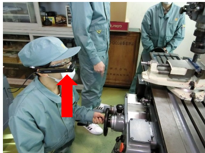
図2 AR メガネを着用した機械加工風景
