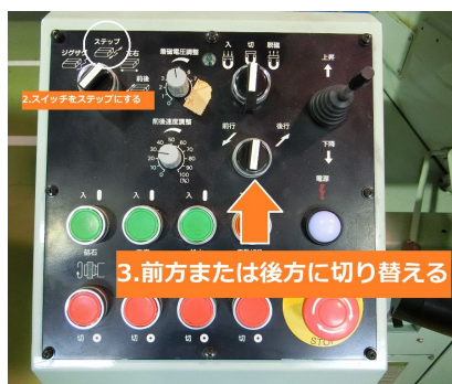
(b)平面研削盤自動送り操作手順
