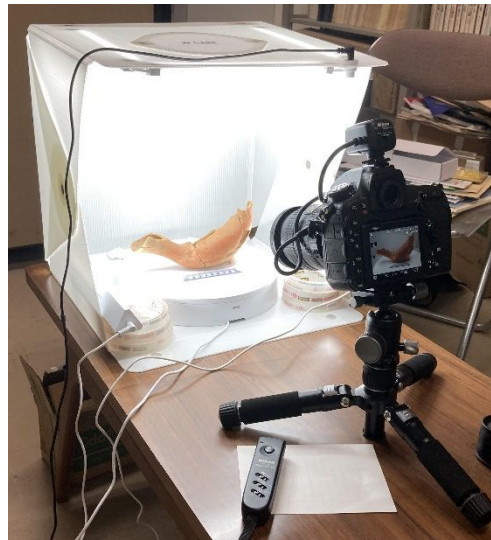
デジタル一眼レフカメラによる SfM 多視点写真測量風景
