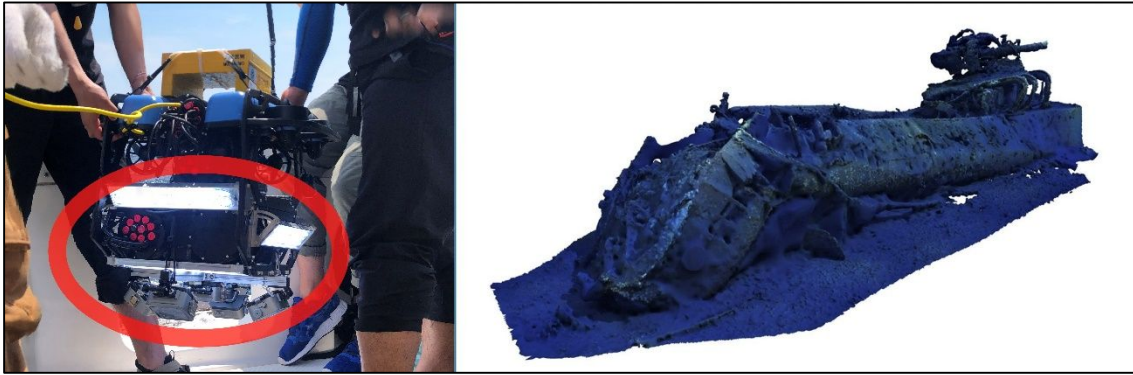
図 2.(左)本研究で開発した水中ドローン搭載用のフォトグラメトリ専用アクセサリの 2 号機。 (右) 2 号機で作成した駆逐艦 藤 (船尾部) のデジタル 3D モデル。
