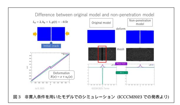
よる断裂のように移動する外部拘束条件を持つ場合について、さらに内部接触面の非貫入条件を課した 2 次元のき裂進展現象のシミュレーションを行い、ブレードの間隔がある値より大きい場合にき裂断面形状が大きく変形することがわかった。これらの結果を、国際会議 ICCCM2023 において発表した。また国際会議 ICIAM2023 においてミニシンポジウム "FreeFEM software package for finite element modeling of PDEs"をオーガナイズし、FreeFEM によってこのアルゴリズムをどのように再現したかについて発表し、この際にFreeFEM の開発者の一人である Pierre Jolivet 氏 (CNRS)を招き、効率的な数値計算について議論を行った。
