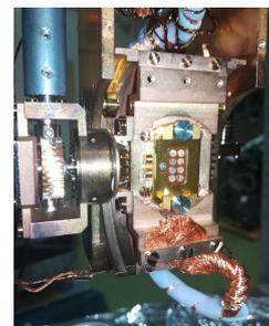
写真4: 8極電極付マニピュレータ。
