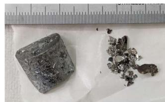
写真1:ブリッジマン法で作成した  $Pb_{0.6}Sn_{0.4}Te$ (左)単結晶と化学気相輸送法で作成した  $SnTe$ (右)単結晶。
