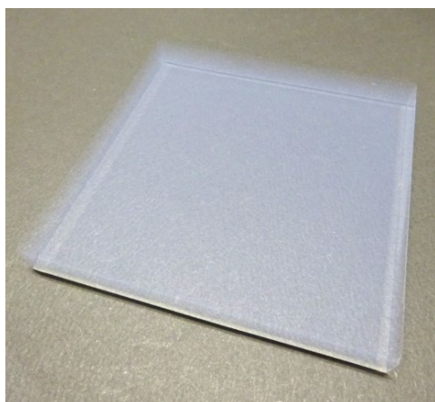
図1 (左) 屈折率1.03の試作エアロゲル。大きさ約11×11×1 cm。(右) 屈折率1.03のエアロゲルの波長400 nmにおける透過長の変遷。1990年代(当時の製法の再現による。参考文献[2])から2000年代(参考文献[3])を経て2020年代(本研究)まで。
