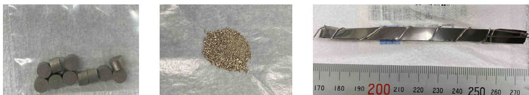
図 1 3 種類の水素吸蔵合金 . 左から (1) Zr-V-Fe Alloy、(2) La-Ni-Al Alloy、(3) Ti Sheet である。
