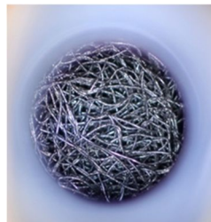
図 2 内径 18mm のアルミ繊維多孔質体を充填した伝熱管
