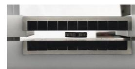
そこで、理論的考察に立ち戻るべく文献調査を含めて再検討を行ったところ、文献[5]における、べき展開近似を用いた安定解析に基づいた考察により、安定磁気浮上振動子の平衡点において、鉛直方向の保持剛性と水平方向の保持剛性にトレードオフが存在する、具体的には両者の線形和の上限が、負の磁化率の絶対値等で決定される一定値で押さえられることを見出した。これは、垂直方向の固有振動数と水平方向の固有振動数のパレートフロントが  $1/4$  楕円形状になることを意味している。なお、本研究の範囲では非接触浮上を実現できなかったものの、反磁性複合材料板の導入により、管壁との接触による摩擦減衰を 10%程度低減する効果があったことを実験的に確認している。
