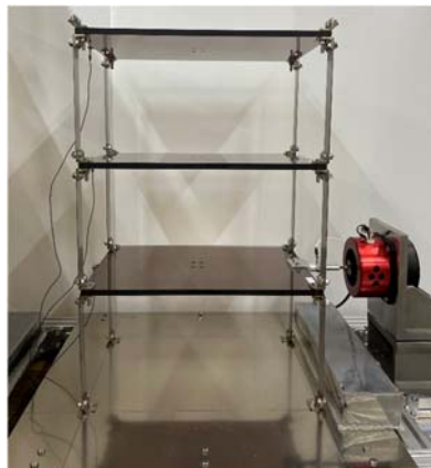
図1 第1層を加振する3層構造物
