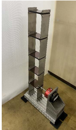
図3 第1層を加振する五層構造物
