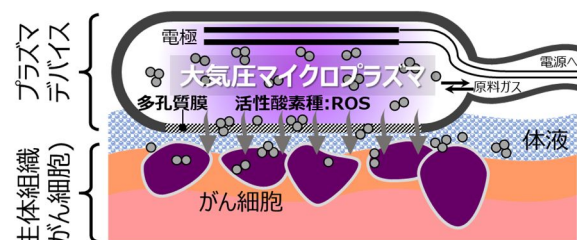
図1. 「多孔質膜プラズマ源」による生体内プラズマ直接照射法のイメージ
