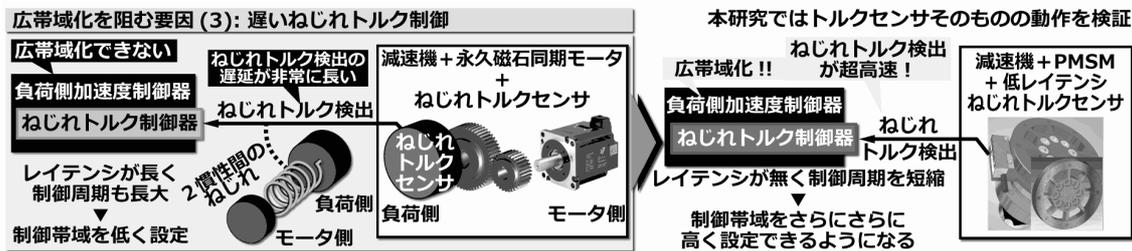
図2 加速度制御系の広帯域化を阻む要因(3)とねじれトルクセンサによる解決方法
