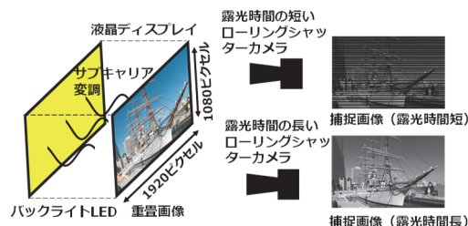
図 2 複眼カメラによる重畳画像の補正
