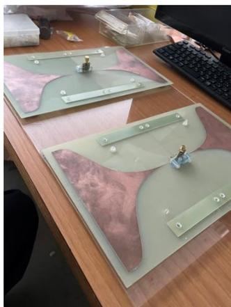
図7 内蔵するボウタイアンテナと作成したシールド
