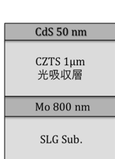
図 3-A CZTS 薄膜太陽電池構造概略
