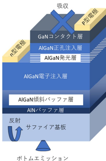
図 1. 従来の LED 構造
