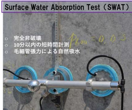
SWATのような実構造物を対象とした吸水・透水試験や、透水試験などは数多く開発されているが、これらの計測結果はすべて、コンクリートの含水率の影響を受ける。この点が、これらの試験方法の実用化を阻んできた最大の障害であった。含水状態をコントロールできる室内の試験体ならまだしも、自然環境にある土木構造物に対
